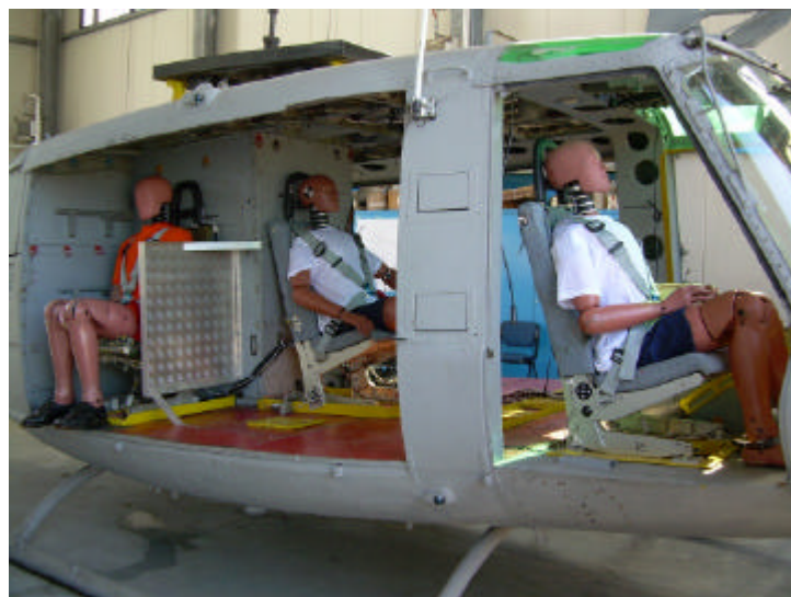
Fig. 1 Articolo di prova con a bordo i manichini che simulano gli occupanti
